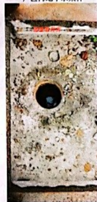
固废暂存库地下水采样
