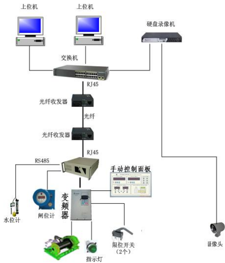
图 15.3-6 闸门自动化监测示意图
