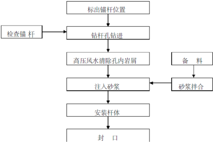
图 8.4-3 锚杆施工工序流程图
