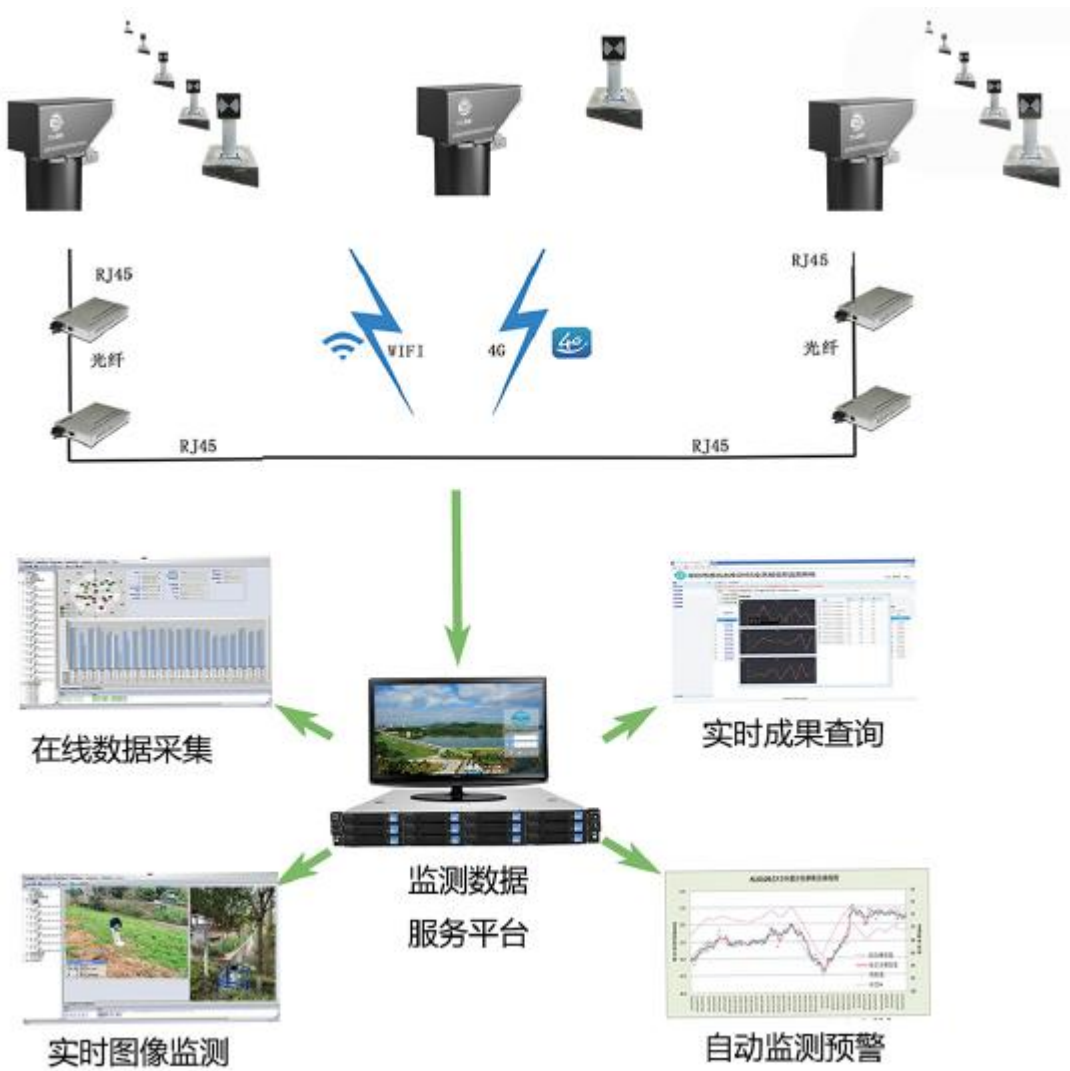
图 15.3-4 机器视觉位移测量系统拓扑图
