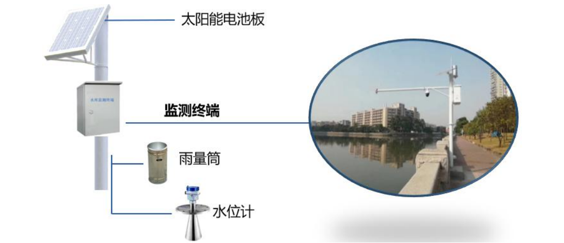
图 15.3-2 遥测雨量水位站组成示意图
